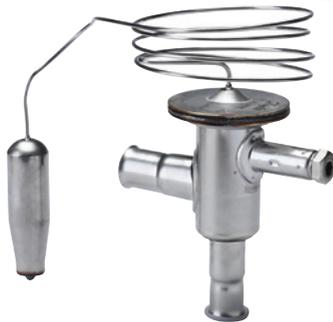
Esta válvula inyecta parte del gas caliente (tomado en la impulsión del compresor) en el tubo entre el evaporador y la aspiración del compresor, manteniendo la temperatura / presión de evaporación constante aproximadamente a +2°C. Esta inyección sirve para impedir la formación de hielo en el evaporador en cualquier condición de carga.
