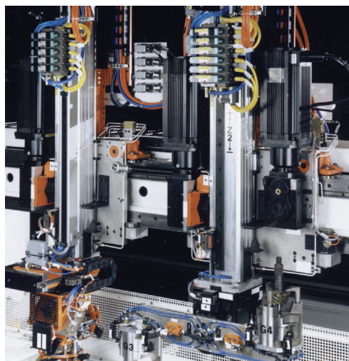
Sistema manipulador de tres ejes
